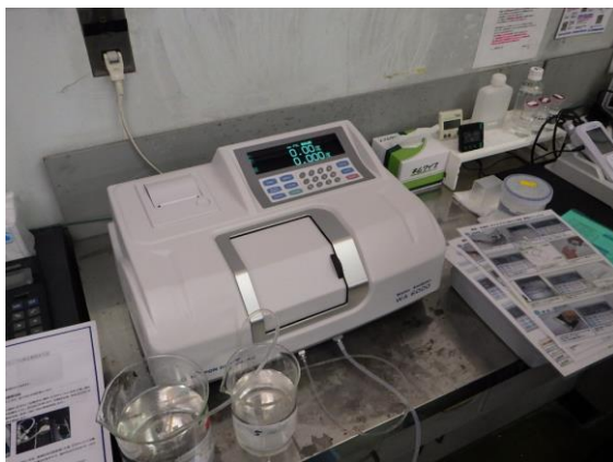
卓上型濁色度計 水質試験室(石川浄水場)
