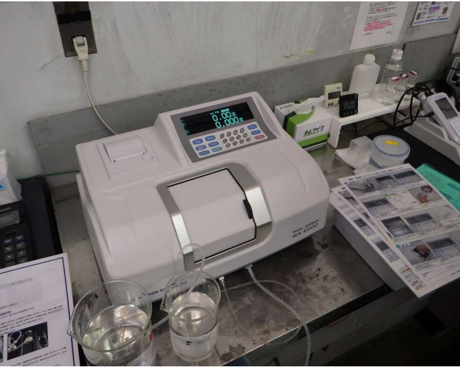
卓 上 型 濁 色 度 計 水 質 試 験 室 ( 石 川 浄 水 場 )
