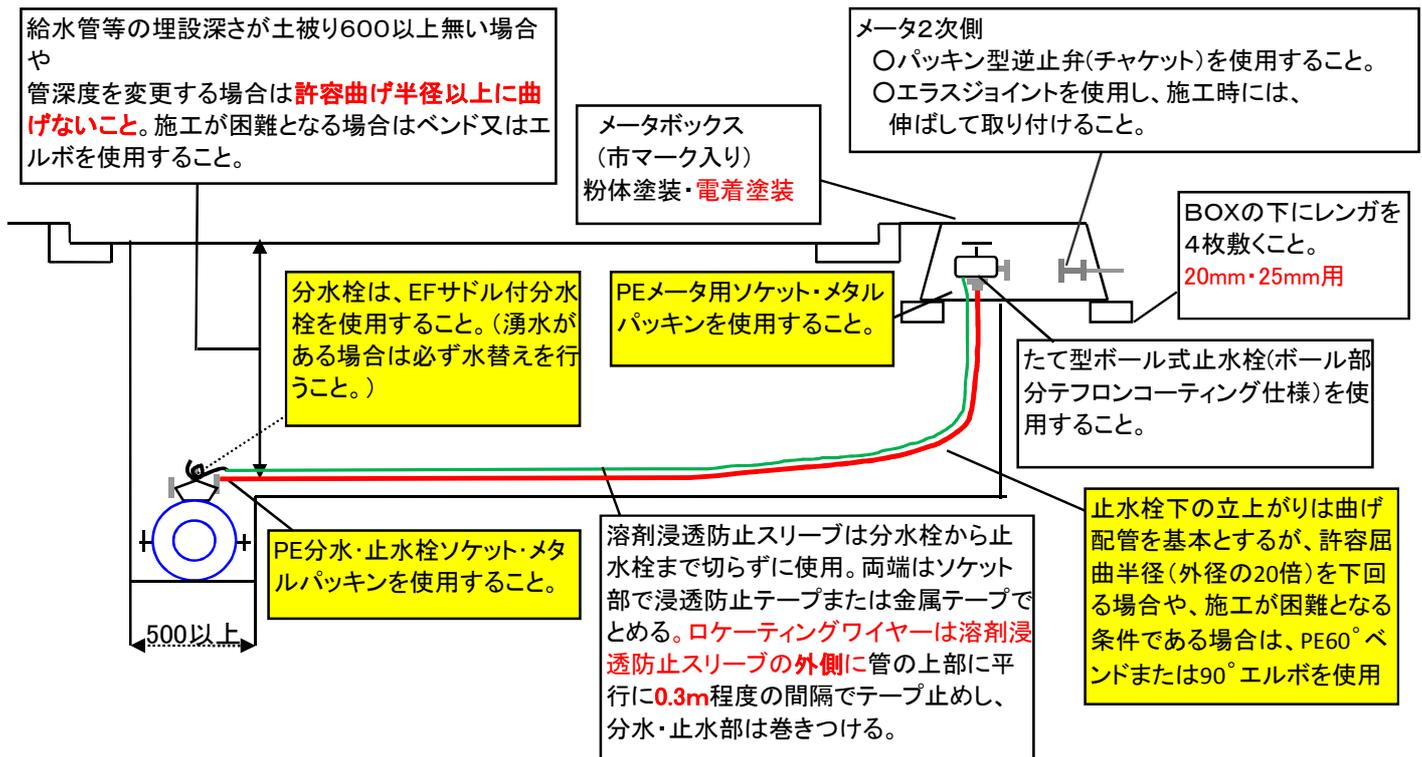
**各継手については、耐震性継手(ワンプッシュ式:インコア打ち込み型)を使用すること。**
