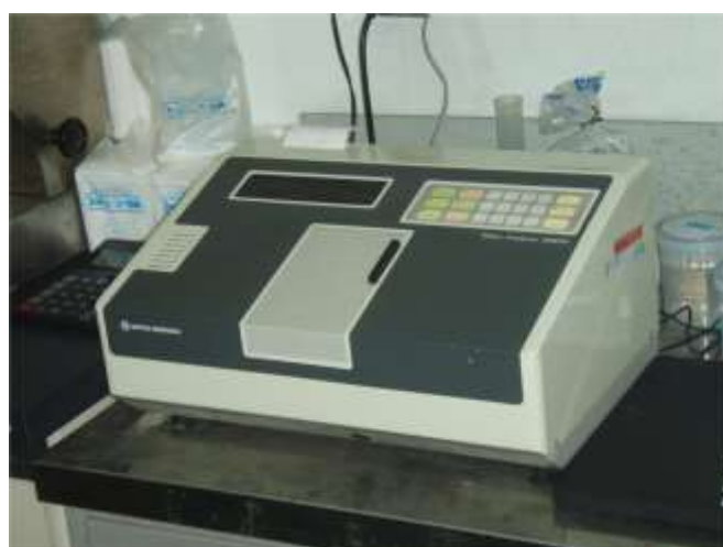
濁色度測定装置 水質試験室(石川浄水場)
